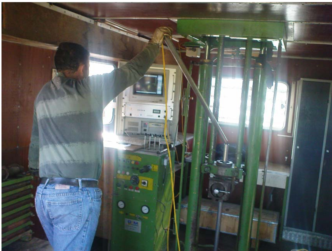
Φωτο 27 : Άποψη του εσωτερικού χώρου στο αυτοκινούμενο στατικό πεντροόμετρο. Διακρίνεται ο ηλεκτρονικός καταγραφέας μετρήσεων (data-logger).
