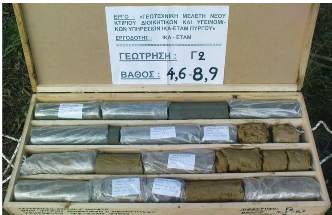
Φωτο 13 : Δείγματα γεώτρησης Γ2, βάθους 4,6 – 8,9 m.
