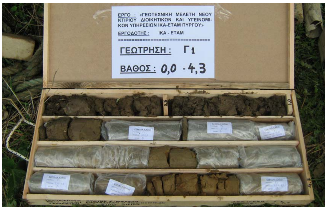
Φωτο 6 : Δείγματα γεώτρησης Γ1, βάθους 0,0 - 4,3 m.
