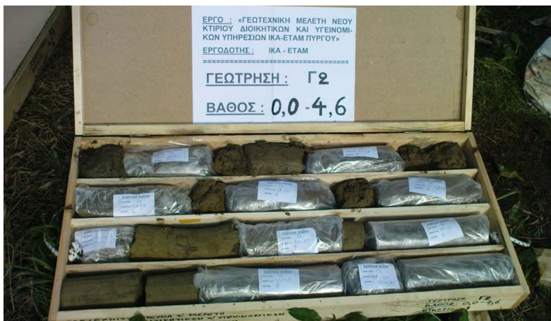
Φωτο 12 : Δείγματα γεώτρησης Γ2, βάθους 0,0 – 4,6 m.
