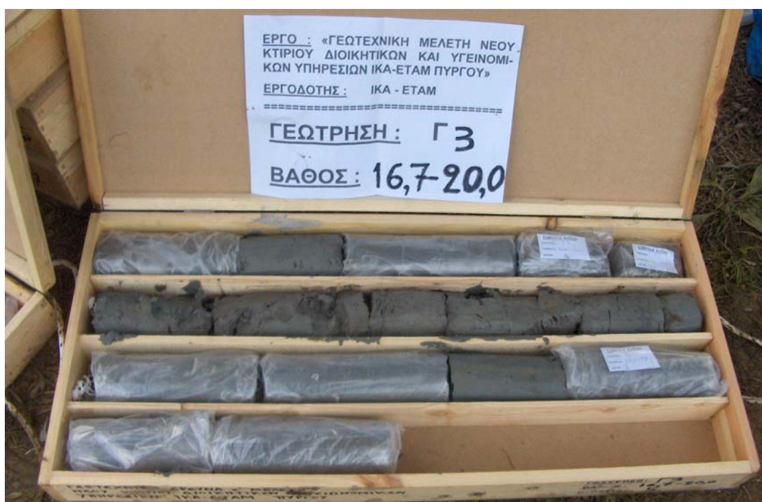
Φωτο 23 : Δείγματα γεώτρησης Γ3, βάθους 16,7 – 20,0 m.
