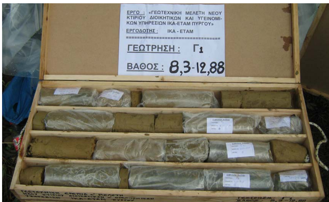
Φωτο 8 : Δείγματα γεώτρησης Γ1, βάθους 8,3 – 12,88 m.
