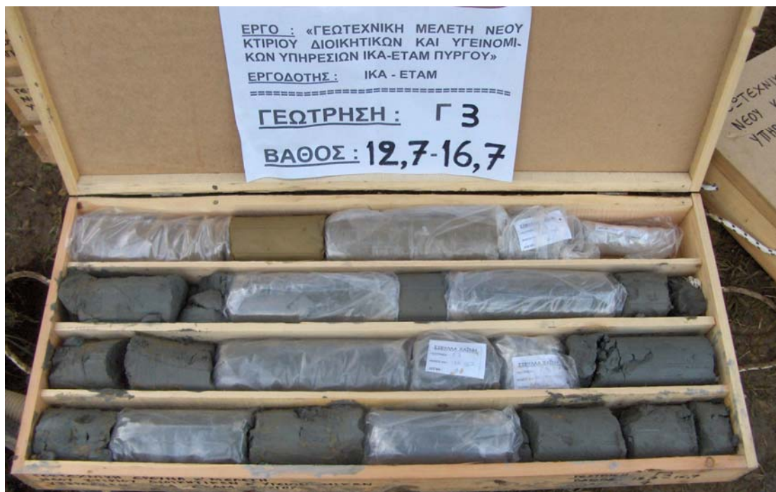
Φωτο 22 : Δείγματα γεώτρησης Γ3, βάθους 12,7 – 16,7 m.
