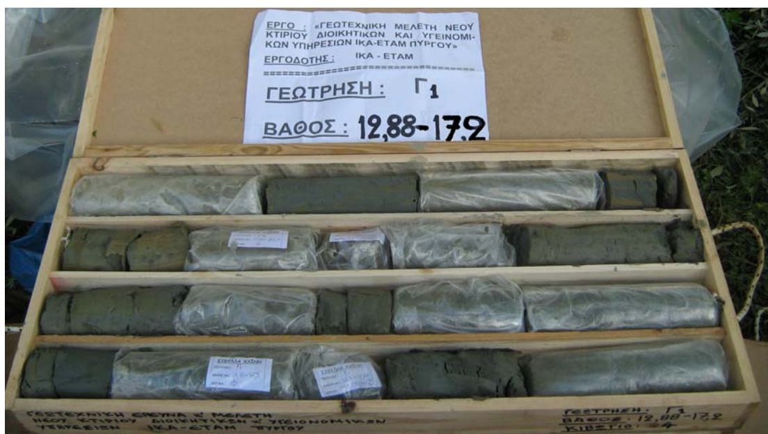
Φωτο 9 : Δείγματα γεώτρησης Γ1, βάθους 12,88 – 17,2 m.
