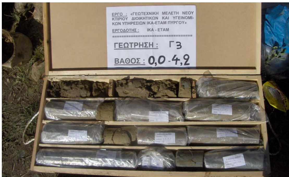
Φωτο 19 : Δείγματα γεώτρησης Γ3, βάθους 0,0 – 4,2 m.
