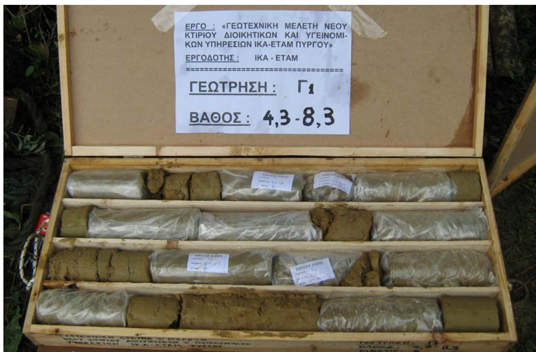
Φωτο 7 : Δείγματα γεώτρησης Γ1, βάθους 4,3 - 8,3 m.
