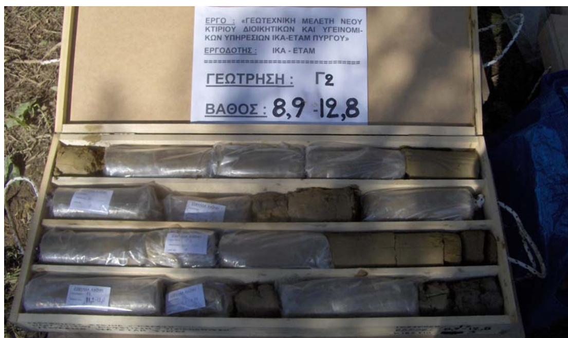
Φωτο 14 : Δείγματα γεώτρησης Γ2, βάθους 8,9 – 12,8 m.
