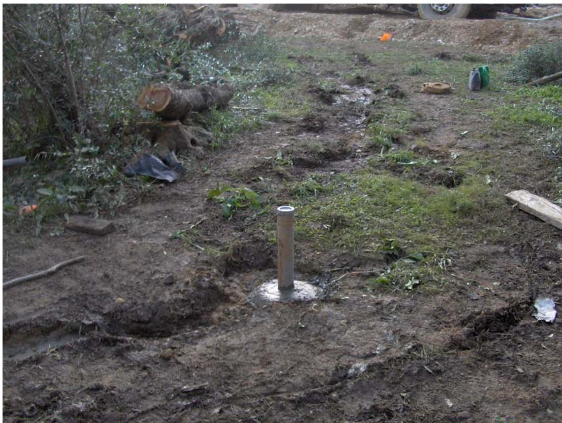
Φωτο 17 : Πιεζόμετρο στην γεώτρηση Γ2.
