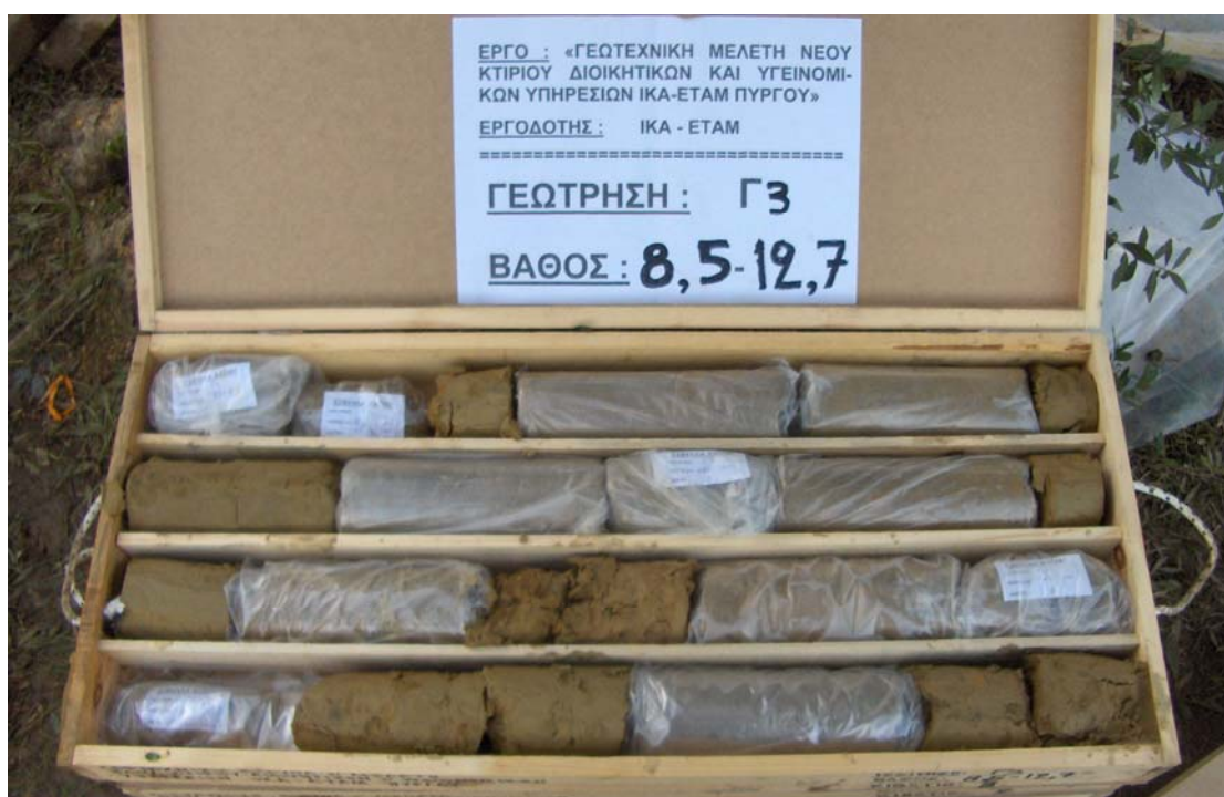
Φωτο 21 : Δείγματα γεώτρησης Γ3, βάθους 8,5 – 12,7 m.
