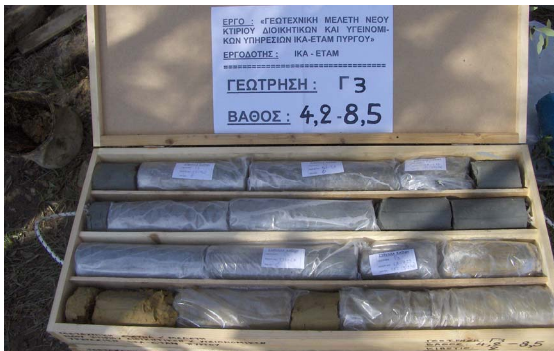
Φωτο 22 : Δείγματα γεώτρησης Γ3, βάθους 4,2 – 8,5 m.
