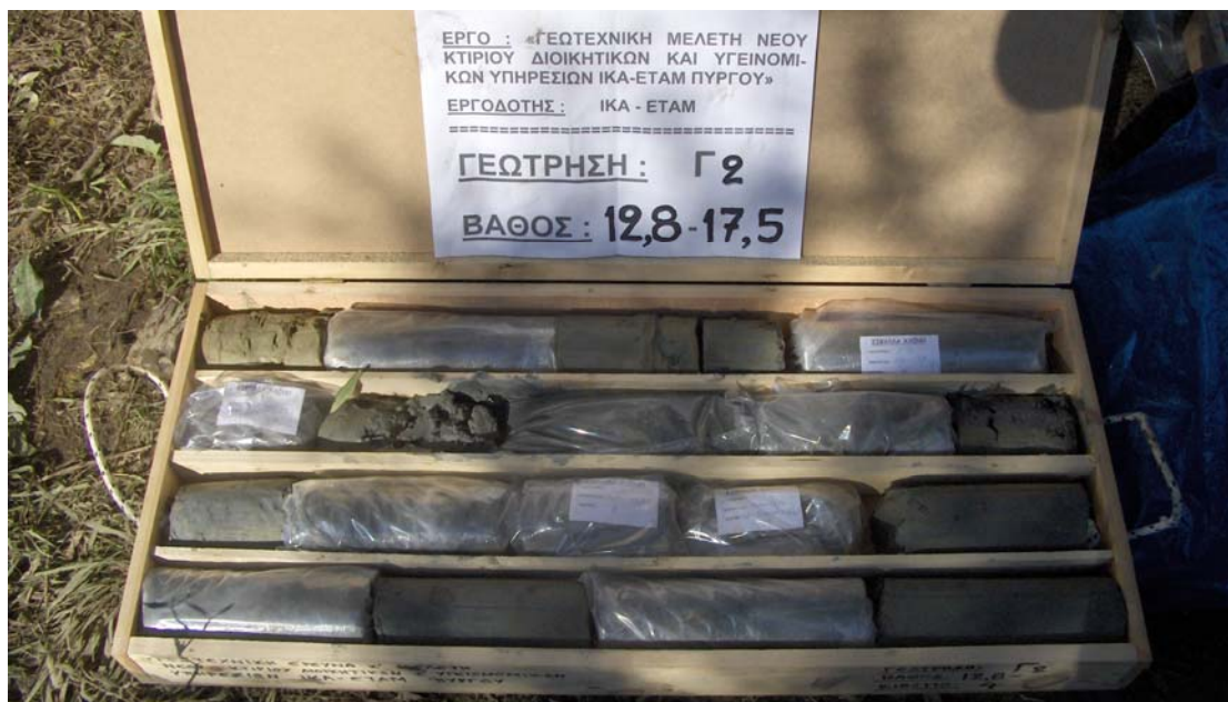
Φωτο 15 : Δείγματα γεώτρησης Γ2, βάθους 12,8 – 17,5 m.
