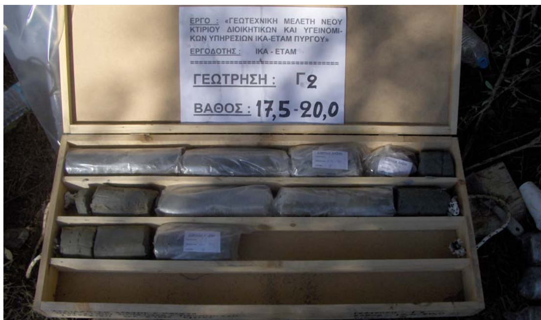
Φωτο 16 : Δείγματα γεώτρησης Γ2, βάθους 17,5 – 20,0 m.
