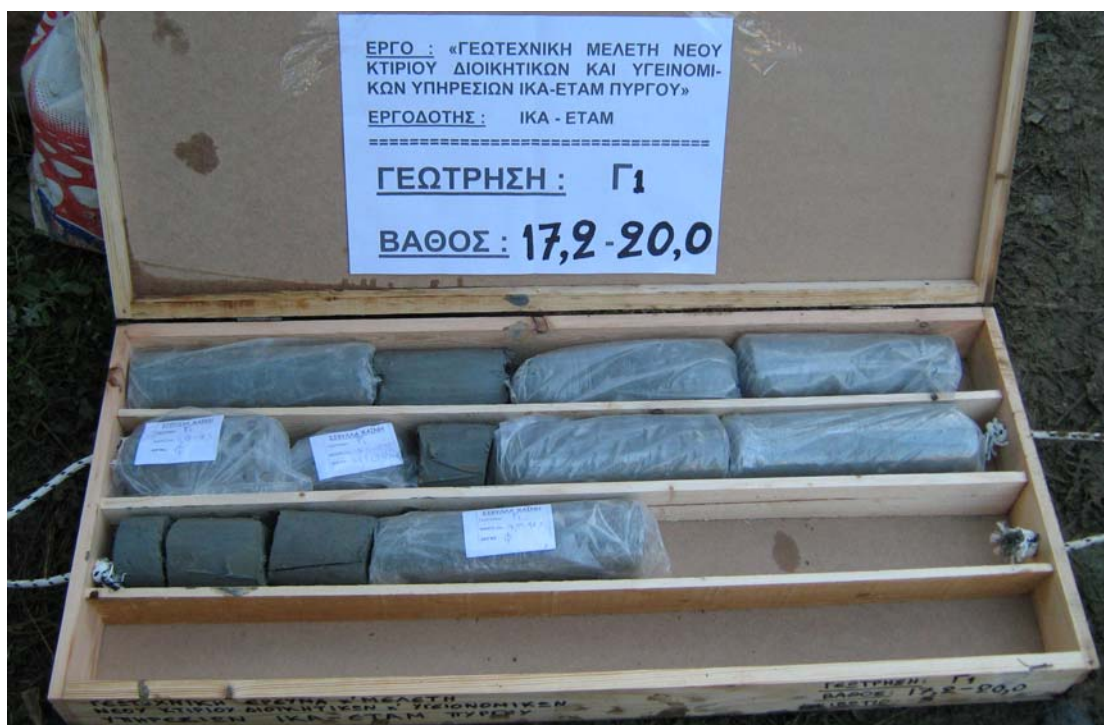
Φωτο 10 : Δείγματα γεώτρησης Γ1, βάθους 17,2 – 20,0 m.
